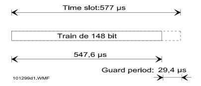
Figure 5 : Structure d'un "time slot"
